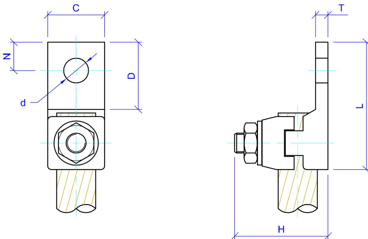
Figura 1 - Vistas frontal e lateral do Conector Terminal Reto Bimetálico Tipo Sapata
